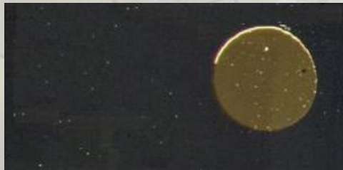
Muestra de Ge con un diodo de Au
